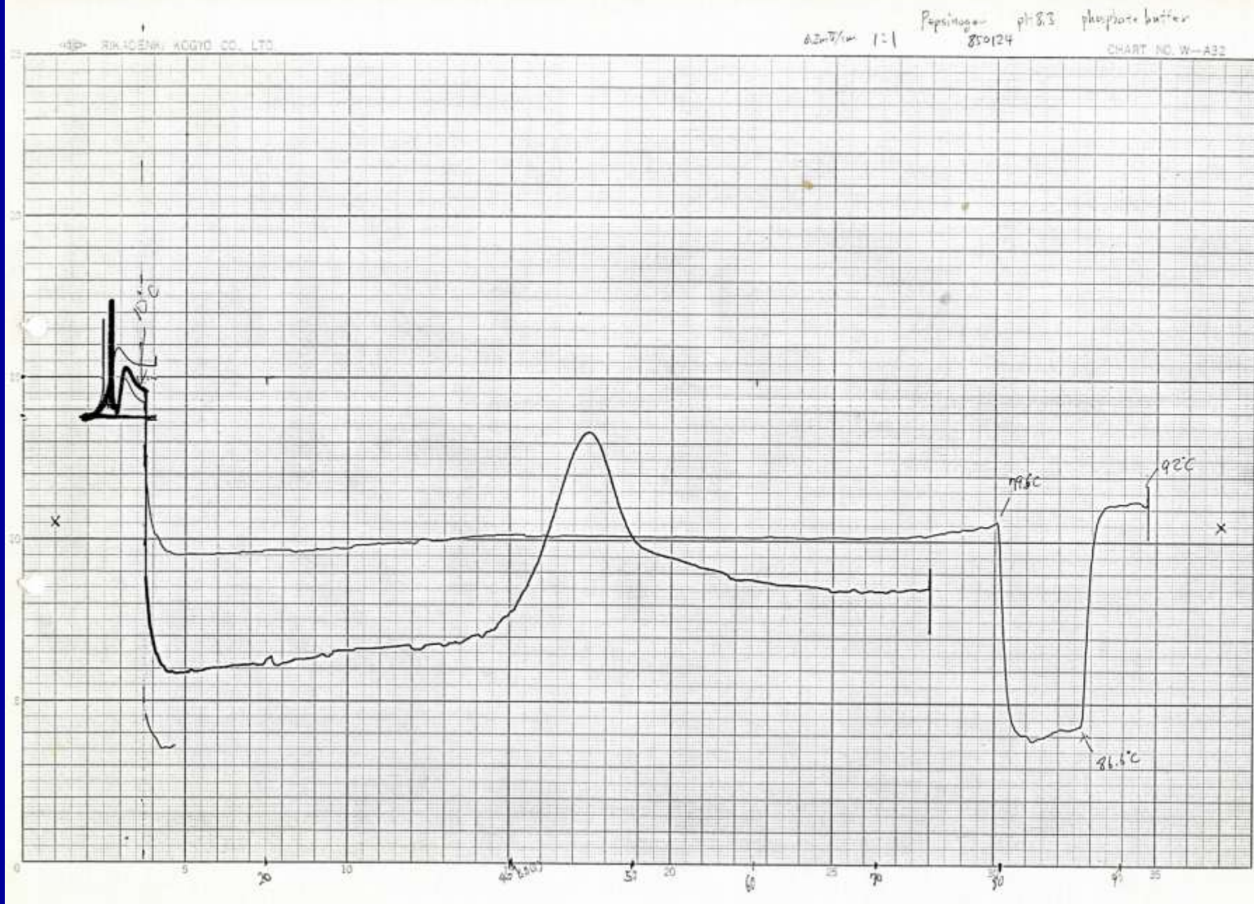
人生最初のDSC測定チャート (pepsinogen, pH 8.3, 1985年1月24日、工技院・織高研 DASM-1M)
